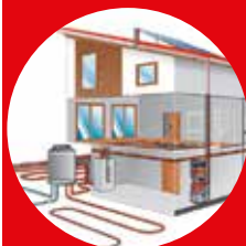
POMPE À CHALEUR
